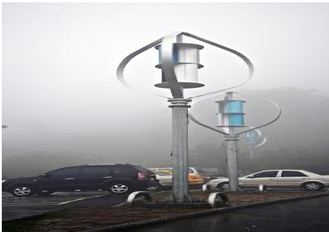
Εικόνα 3.3.1.4 Συνδυασμός Α/Γ τύπου Savonius και Darrieus σε μια(7)
