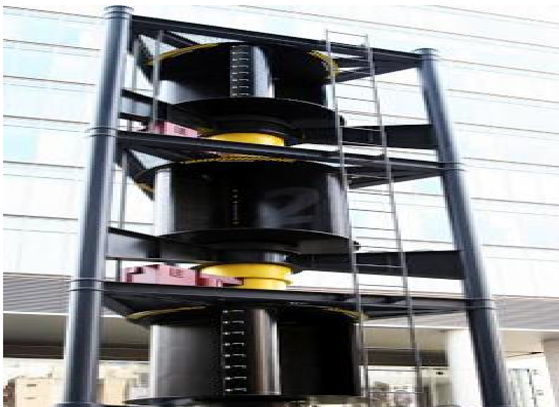
Εικόνα 3.3.1 Σύστημα με 3 Α/Γ τύπου Savonius(3)
