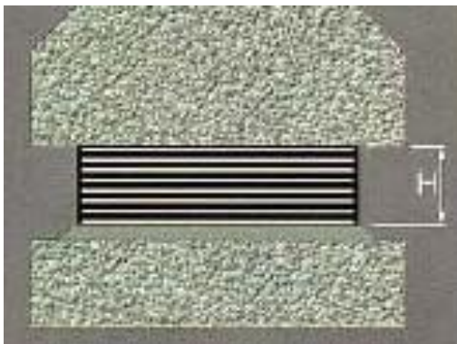
Ελαστομεταλλικά μή αγκυρούμενα (Τύπου 1).
