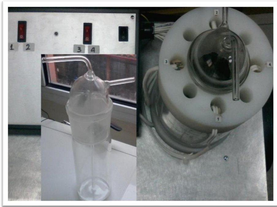
Εικόνα 36: Φωτοκαταλυτικό σύστημα που χρησιμοποιήθηκε για την διεξαγωγή του πειράματος
