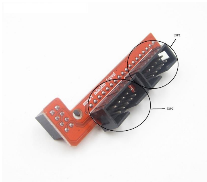
Εικ. 4.8.3 μετατροπέας σύνδεσης διαύλων έξυπνου ελεγκτή με το RAMPS
