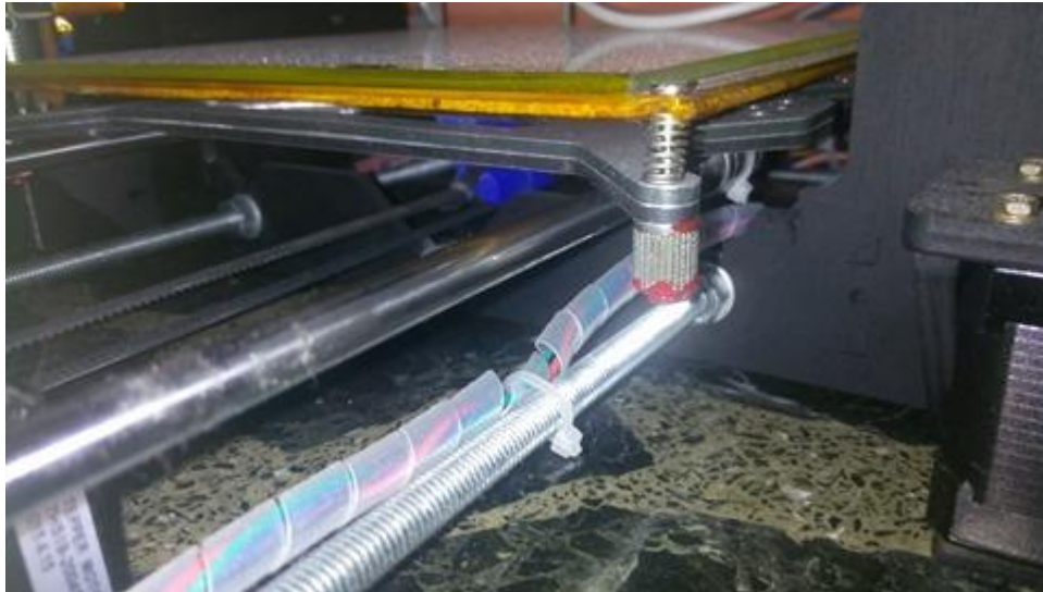
Εικ. 4.2.19 Είδος ανάρτησης για απόσβεση κραδασμών.
