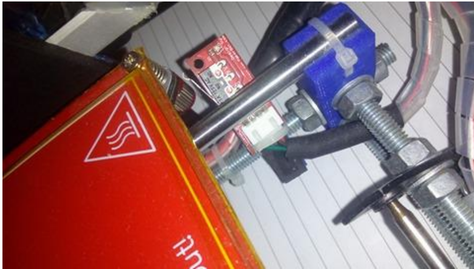
Εικ. 4.2.23 Τοποθέτηση μηχανικού τερματικού διακόπτη.
