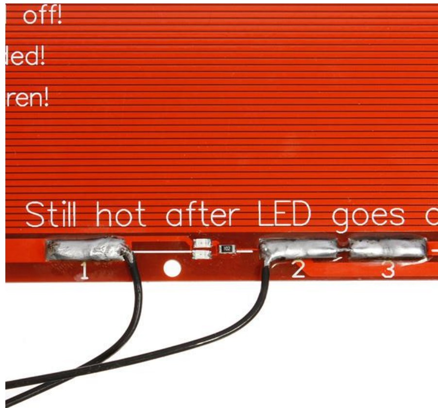
Εικ. 4.2.15 Ακροδέκτες και τρόπος σύνδεσης
