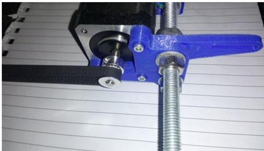
Εικ. 4.2.8 Βάση στήριξης του κινητήρα μπροστινή όψη.
