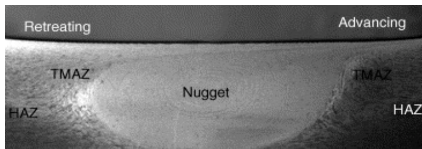
Σχήμα 2.8: Τυπική μακρογραφική αναπαράσταση των ζωνών (απλό σχήμα ακίδα 400rpm και 51mm/min)
