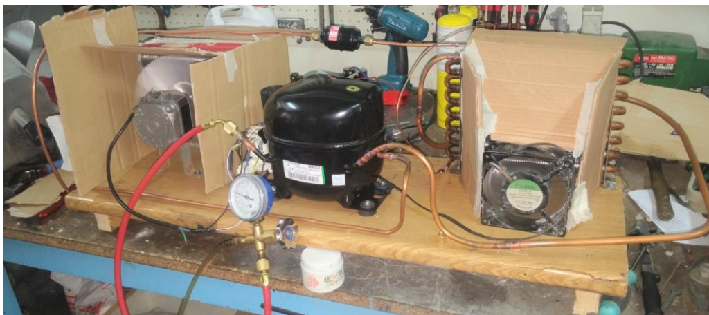
Εικόνα 2.21: Δοκιμές με Καλύτερη Ροή Αέρα
