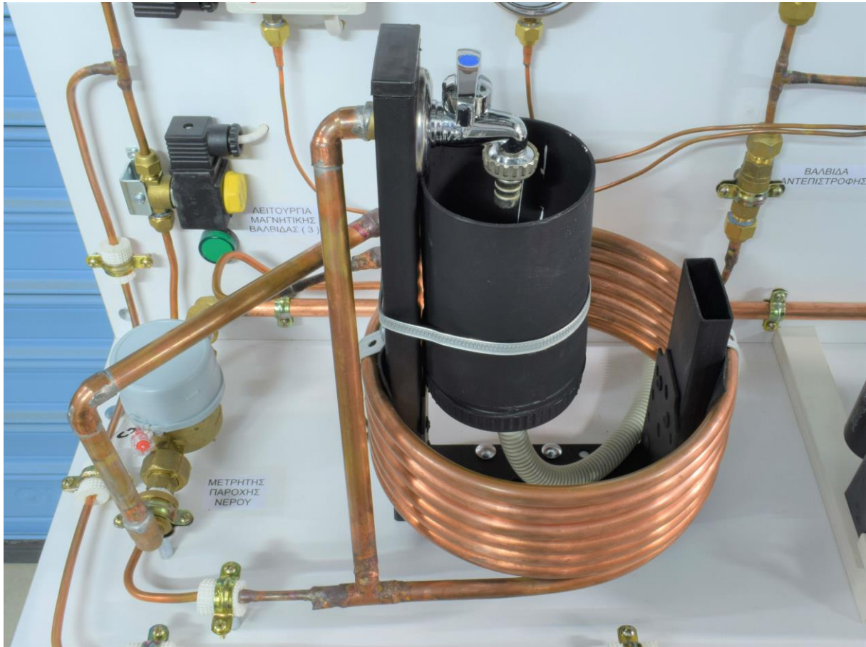
Εικόνα 2.54: Τοποθετημένος Συμπυκνωτής Νερού
