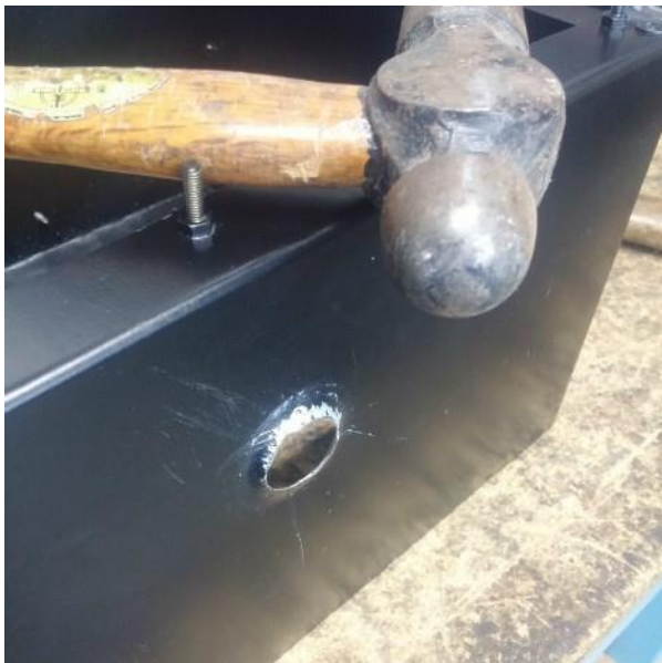
Εικόνα 2.60: Σφυρηλάτηση με Ειδικό Σφυρι για Διαμόρφωση της Τρύπας Αποχέτευσης
