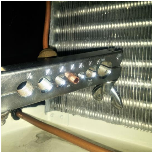
Εικόνα 2.71: Διαδικασία Εκχύλωσης για Σύνδεση της Βαλβίδας
