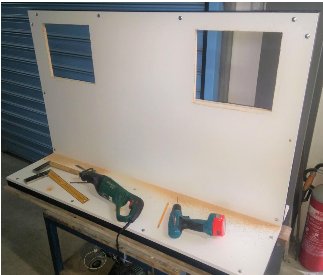
Εικόνα 2.29: Κοπή Μελαμίνης για την Τοποθέτηση των Εναλλακτών Αέρα
