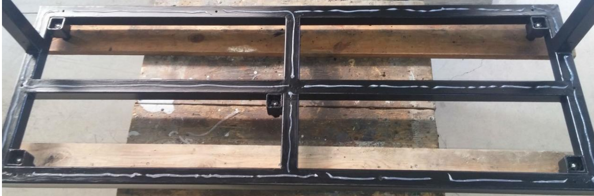
Εικόνα 1.10: Σιλικόνη Επάνω Στις Πλευρές Επαφής
