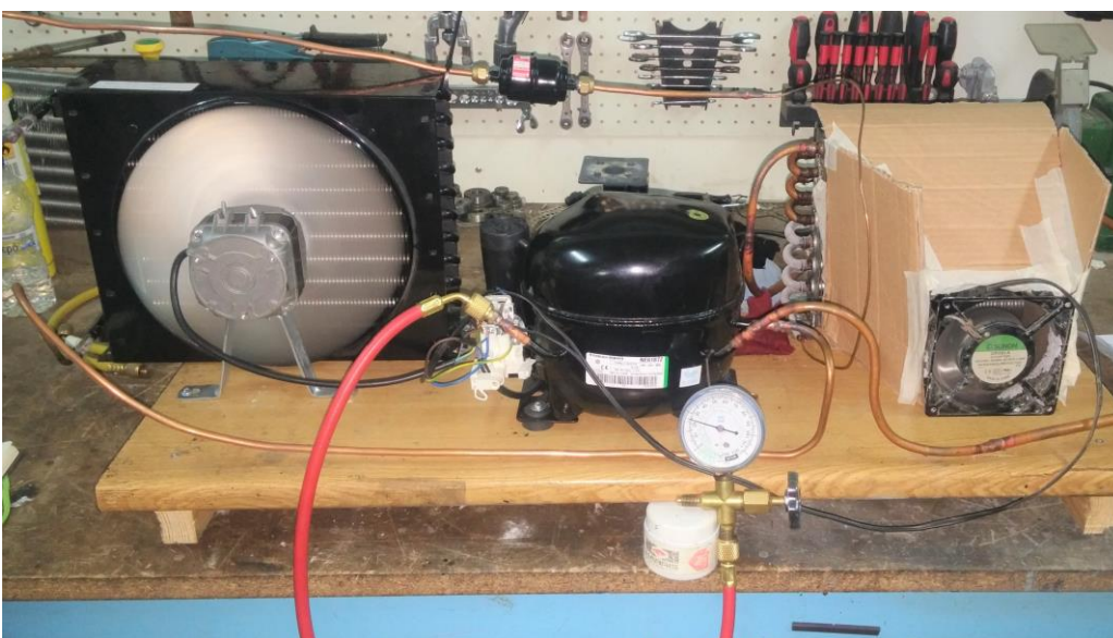
Εικόνα 2.23: Λειτουργία με Κανονικό Συμπυκνωτή
