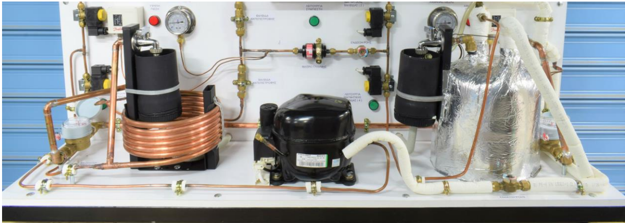
Εικόνα 2.46: Αριστερά Συμπυκνωτής Νερού - Δεξιά Εξατμιστής Νερού
