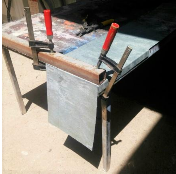
Εικόνα 2.59: Σφυρηλάτηση Λαμαρίνας για Διαμόρφωση της
