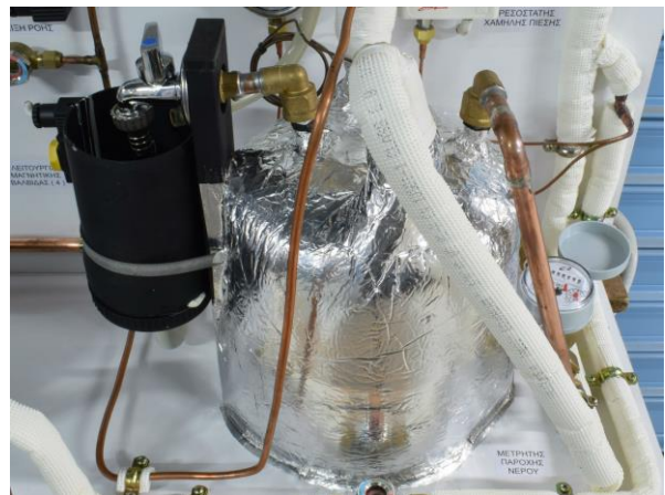
Εικόνα 2.45: Μονωμένος Εξατμιστής Νερού
