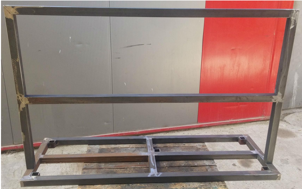
Εικόνα 1.4: Έτοιμος Μεταλλικός Σκελετός
