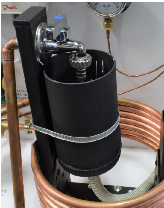
Εικόνα 4.11: Δοχείο Νερού - Συμπυκνωτής
