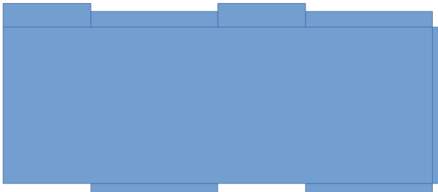
Εικόνα 2.56: Σχέδιο Διαμόρφωσης Λαμαρίνας
