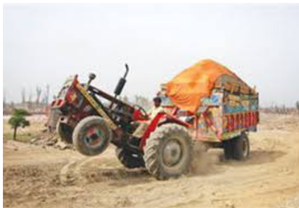
Εικόνα 4. Ανατροπή του γεωργικού ελκυστήρα προς τα πίσω
