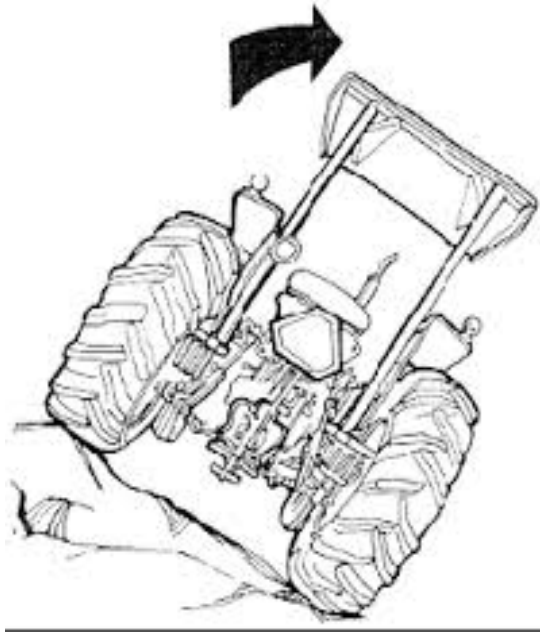
Εικόνα 1. Ανατροπή του γεωργικού ελκυστήρα προς τα πλάγια
