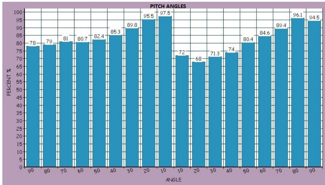
Εικόνα Μ. Ακρίβεια μετρήσεων γωνιών pitch από το ψηφιακό κλισίμετρο σε ποσοστό επί τις 100.
