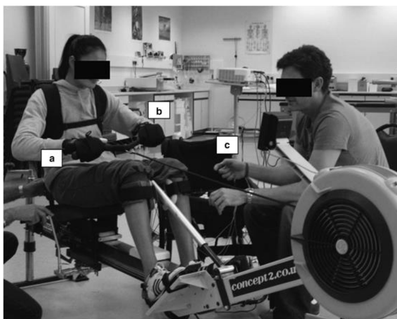
(Εικόνα 3.4. Το τροποποιημένο μηχάνημα που επιτρέπει το FES-R σε τετραπληγικούς ασθενείς. (a) Ιμάντες ώμου (b) Γάντια νεοπρενίου (c) Κουμπί εναλλαγής (Gibbons et al. 2014)
