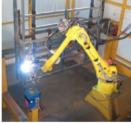
Εικόνα 1.5: Ρομπότ σταθερής βάσης, ρομποτικός βραχίονας συγκόλλησης (εικόνα από Towers Engineering Works www.teworks.com.au )
