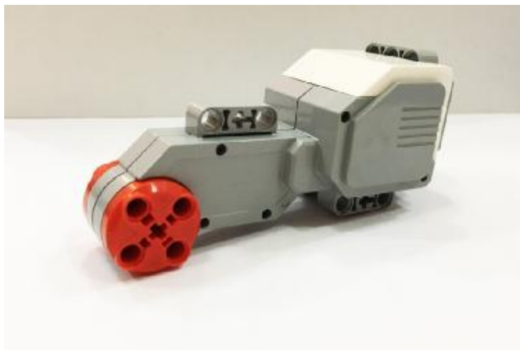
Εικόνα 2.12: Μεγάλος Κινητήρας με Ενσωματωμένο Αισθητήρα Περιστροφής (φωτογραφικό υλικό από το προσωπικό μας αρχείο)
