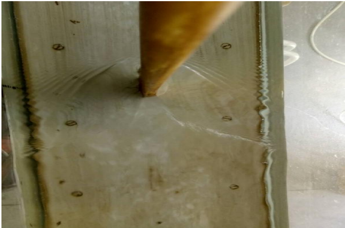
Εικόνα 40: Κάτοψη ροής από βάθρο ορθογωνικής διατομής με δύο ημικυκλικά άκρα
