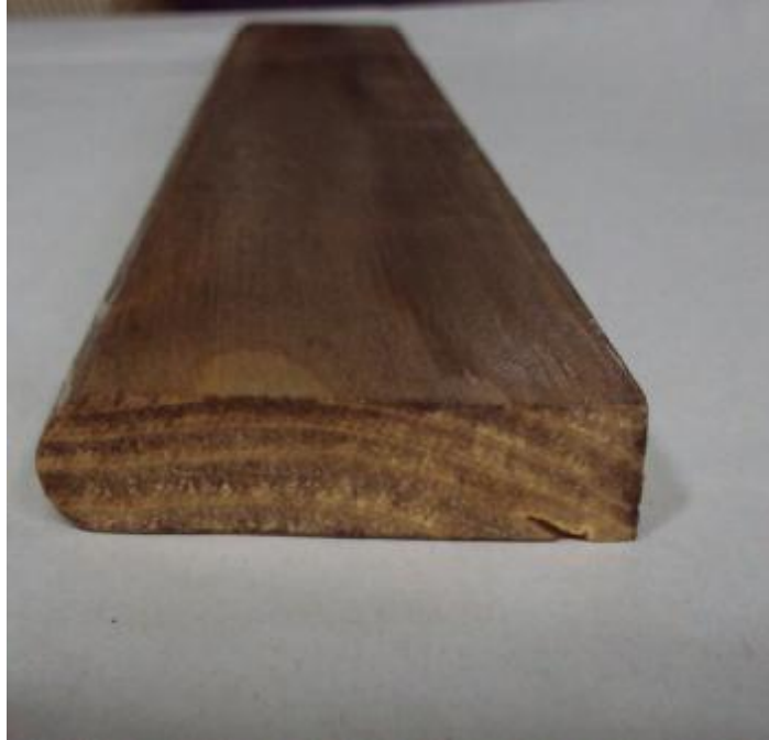
Εικόνα 21: Απεικόνιση ορθογωνικής διατομής με ένα αριστερό ημικυκλικό άκρο μετά το βερνίκι
