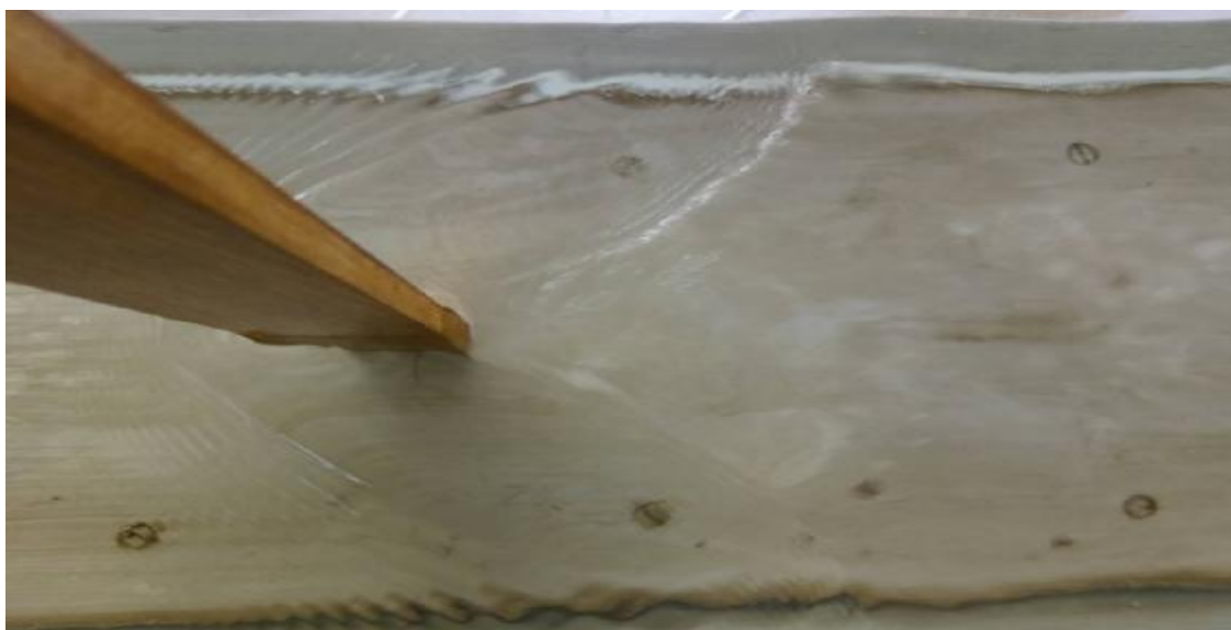
Εικόνα 42: Κάτοψη ροής με βάθρο ορθογωνικής διατομής
