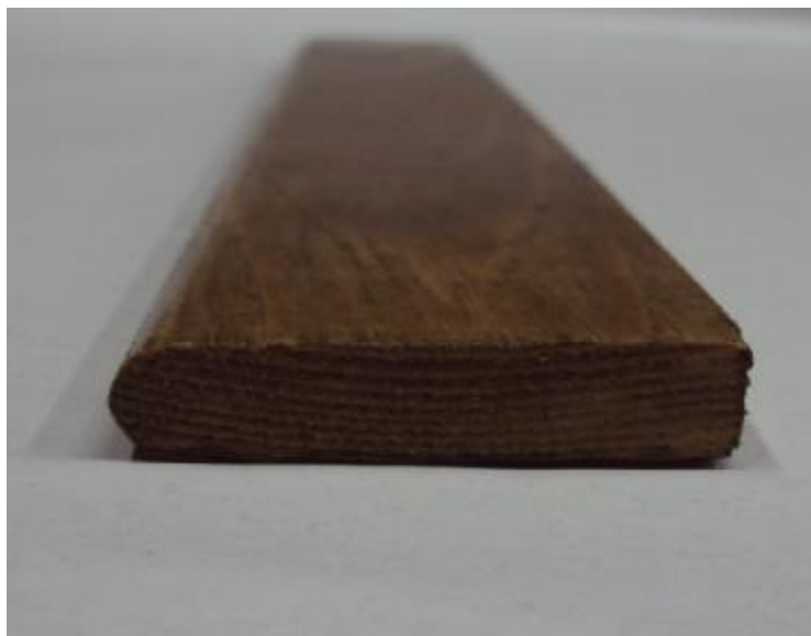
Εικόνα 24: Απεικόνιση ορθογωνικής διατομής με ένα ημικυκλικό άκρο με μικρότερη ακτίνα μετά το βερνίκι
