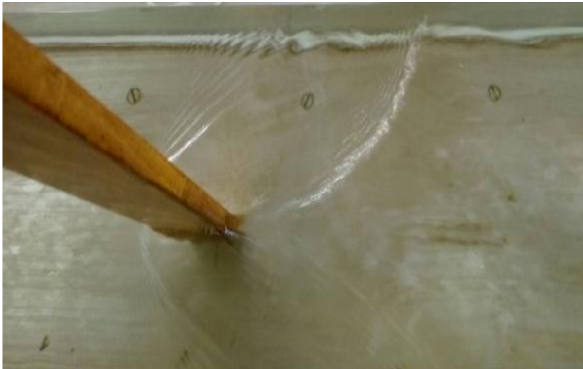
Εικόνα 38: Κάτοψη ροής με βάθρο ορθογωνικής διατομής με ένα αριστερό ημικυκλικό άκρο
