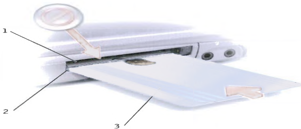
ΕΙΚΟΝΑ 44 : Εγκατάσταση μιας έξυπνης κάρτας
