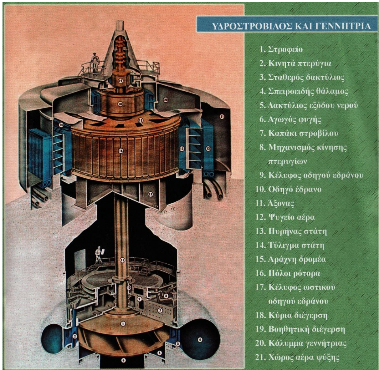
Σχέδιο επεξήγησης λειτουργίας στροβίλου-γεννήτριας
