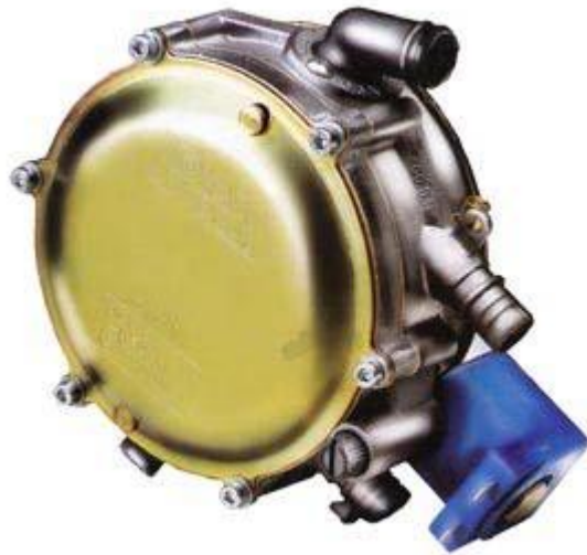
Εικόνα 19: Βαλβίδα εξαέρωσης καυσίμου.
