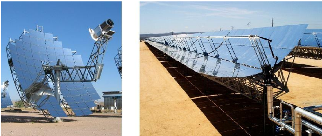
Εικόνα 3.6: α) Συγκεντρωτικός συλλέκτης σημειακής εστίασης, β) Συγκεντρωτικός συλλέκτης γραμμικού τύπου με σωλήνα κενού στο κέντρο
