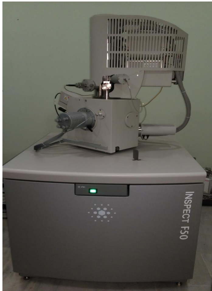
Εικόνα 5.25: Το S.E.M. FEI™ Inspect F50 του Τ.Ε.Ι. Δυτικής Ελλάδας.
