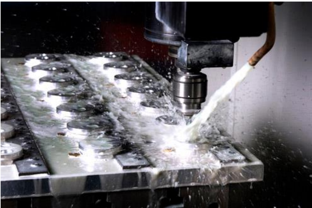
Εικόνα 1.17: Κατεργασία φρεζαρίσματος από φρέζα C.N.C. με χρήση ψυκτικού υγρού υπό πίεση. (πηγή:Elge Precision Machining, Inc )
