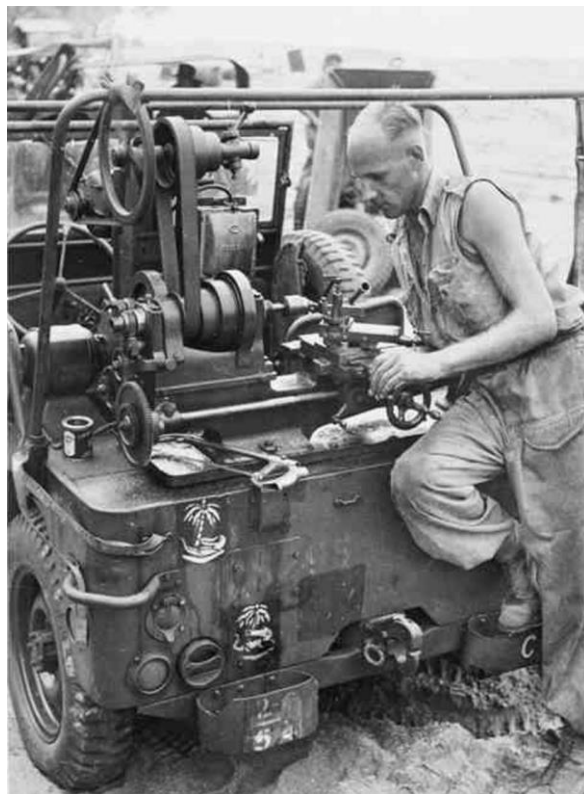
Εικόνα 0.1: Τόρνευση επάνω σε ειδικά διαμορφωμένο Willys MB σε πεδίο μάχης του 2 ου Παγκοσμίου Πολέμου (πηγή: 4 th Australian Armored Brigade)
