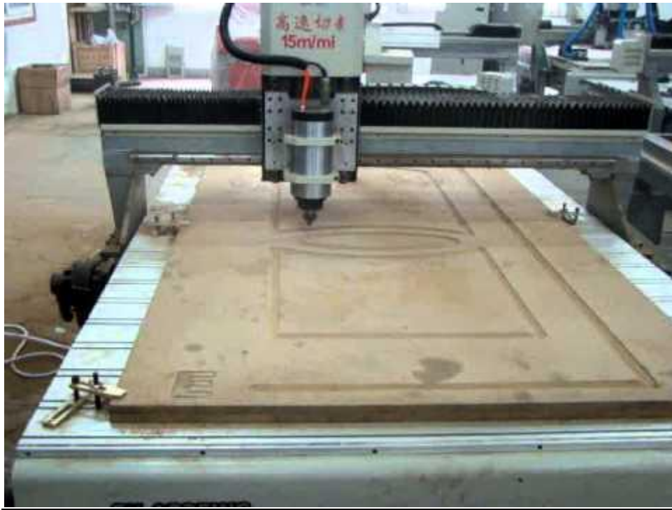
Εικόνα 1.15: C.N.C. φρέζα για κατεργασίες ξύλου. Διακρίνεται ο σερβοκινητήρας.
