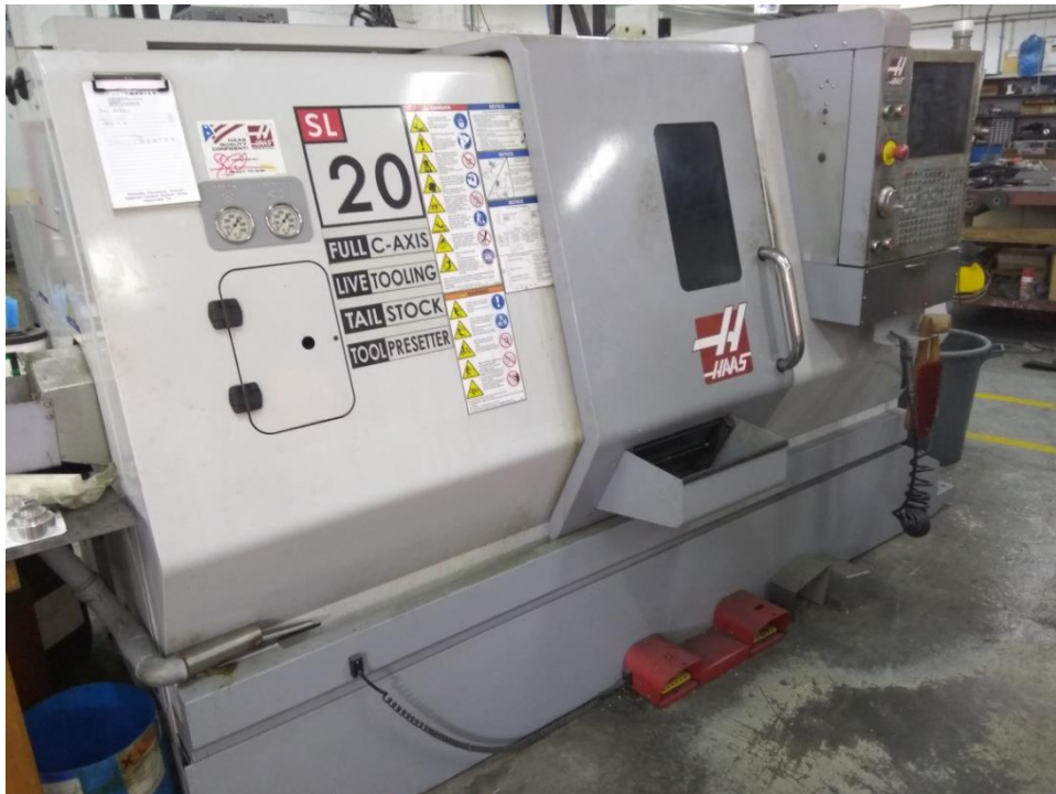
Εικόνα 1.16: Ο C.N.C. τόνος Haas SL 20 του Μ.Υ.Ε.Δ.
