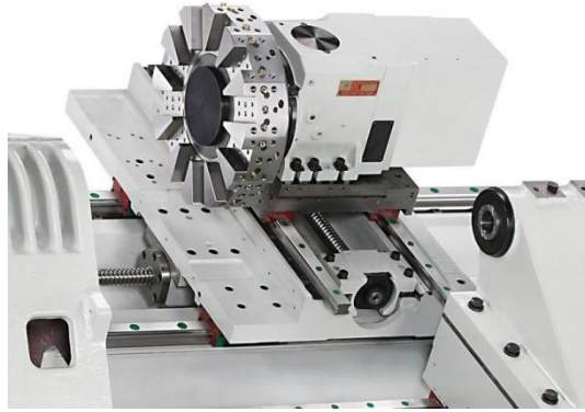
Εικόνα 1.12: Βασικά μέρη C.N.C. τόνου κεκλιμένης διαμόρφωσης, χωρίς το κουβούκλιο ασφαλείας. Διακρίνονται τα γραμμικά ρουλεμάν για την κίνηση κατά μήκος των αξόνων. (πηγή: HPC Services LTD)
