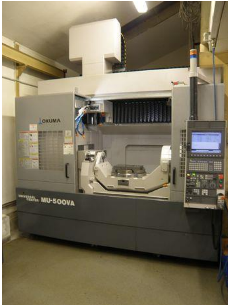
Εικόνα 1.7: C.N.C. Κέντρο Κατεργασίας 5 αξόνων Okuma MU500VA (πηγή: Okuma Corporation)
