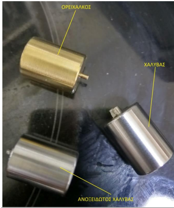
Εικόνα 0.1: Τα δοκίμια νο.10 και των τριών υλικών.
