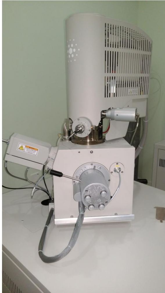
Εικόνα 5.27: Ο θάλαμος τοποθέτησης των δειγμάτων προς μέτρηση, η στήλη εκπομπής ηλεκτρονίων και οι διάφοροι αισθητήρες για την μέτρηση των αποτελεσμάτων.
