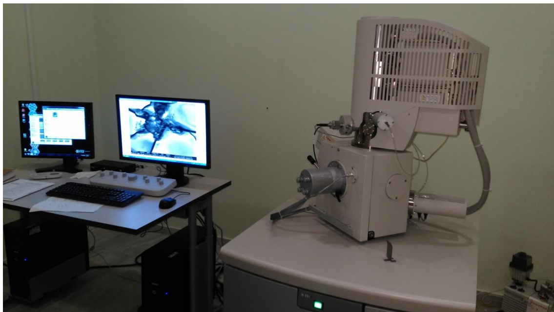
Εικόνα 5.26: Το S.E.M. μαζί με τους υπολογιστές, τις οθόνες προβολής και απεικόνισης και τα χειριστήρια ελέγχου της λειτουργίας του.
