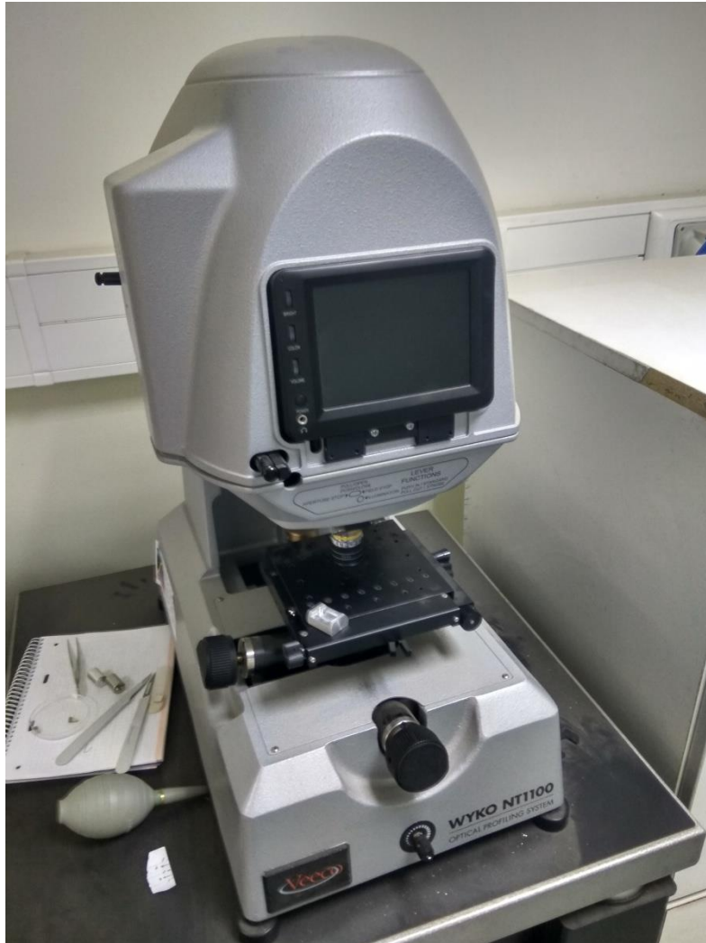
Εικόνα 5.1: Το οπτικό μικροσκόπιο Wyko NT1100 του Ι.Τ.Ε./Ι.Ε.Χ.ΜΗ. Πάτρας και η αλουμινένια ιδιοσυσκευή στήριξης των δοκιμίων προς μέτρηση.
