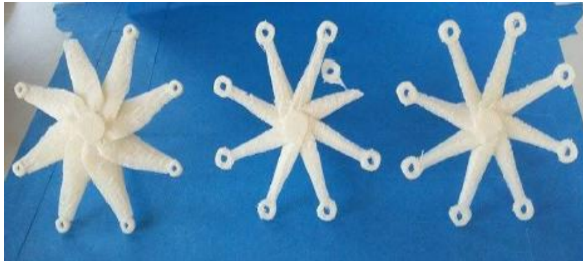
Εικόνα 2.26 : Παρατηρούνται διάφορες προσπάθειες αλλαγής του πάχους των πτερυγίων. Δεξιά παρατηρείται το τελικό επιθυμητό αποτέλεσμα.
