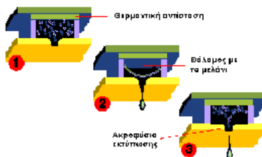
Εικόνα 1.4: Λειτουργία Εκτυπωτή Έγχυσης Μελάνης
