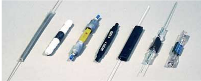
Σχήμα 7.5: Mechanical splicing tubes. Το πρώτο από τα αριστερά χρησιμοποιείται σε fusion splicing. Οι σωλήνες μηχανικής συγκόλλησης έχουν συνήθως και μία μικρή οπή για να μπορεί να διαφεύγει η περίσσεια κόλλας.
