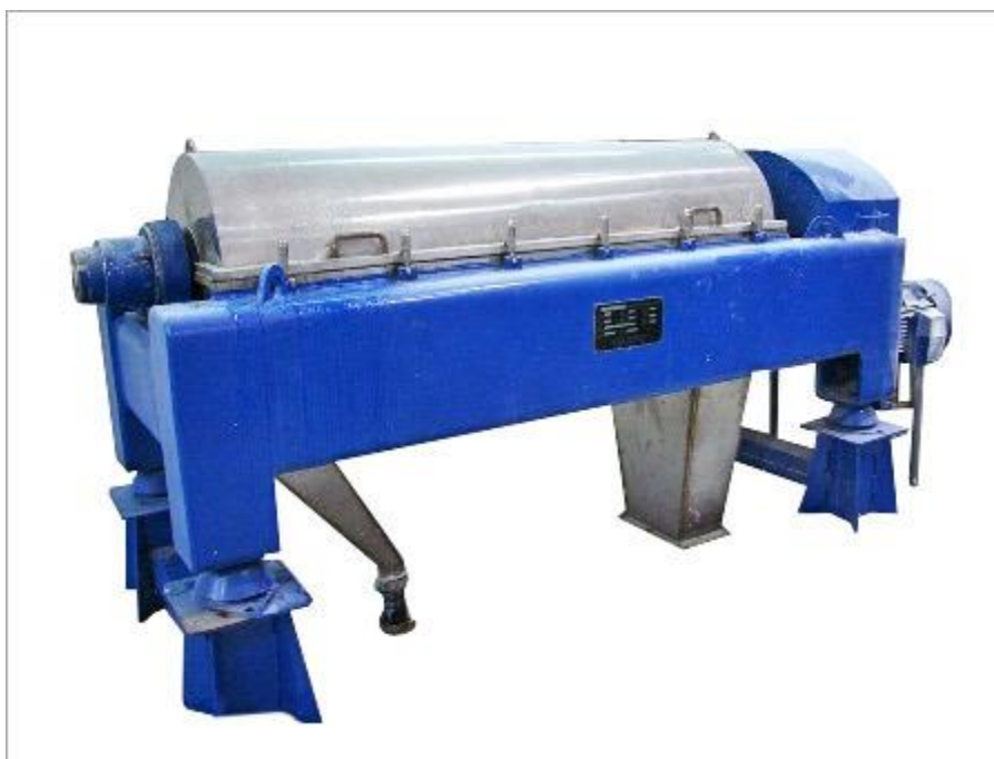
Εικόνα 7: Φυγοκεντρωτής (decanter), όπου διαχωρίζονται λάδι-νερό και στερεά κατάλοιπα.
