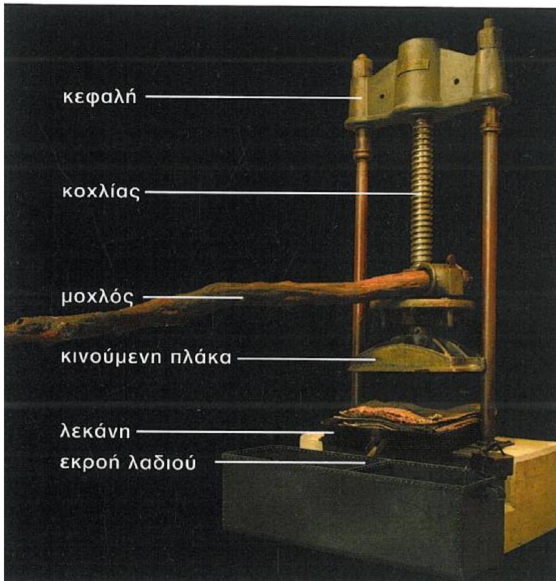
Εικόνα 6: Παλιός τύπος πιεστηρίου με τους ελαιόσακους έτοιμους για την άσκηση πίεσης.
