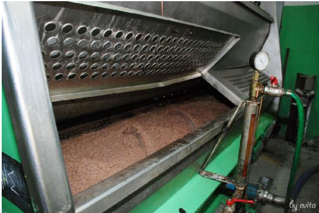
Εικόνα 5:Μάλαξη στους θερμομαλακτήρες, όπου μαλάσσεται η ελαιοζύμη.
