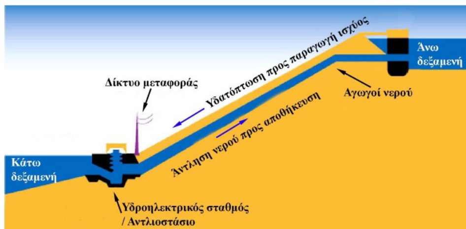
Εικόνα 5.4: Βασική δομή και λειτουργία ενός αναστρέψιμου υδροηλεκτρικού[2]
