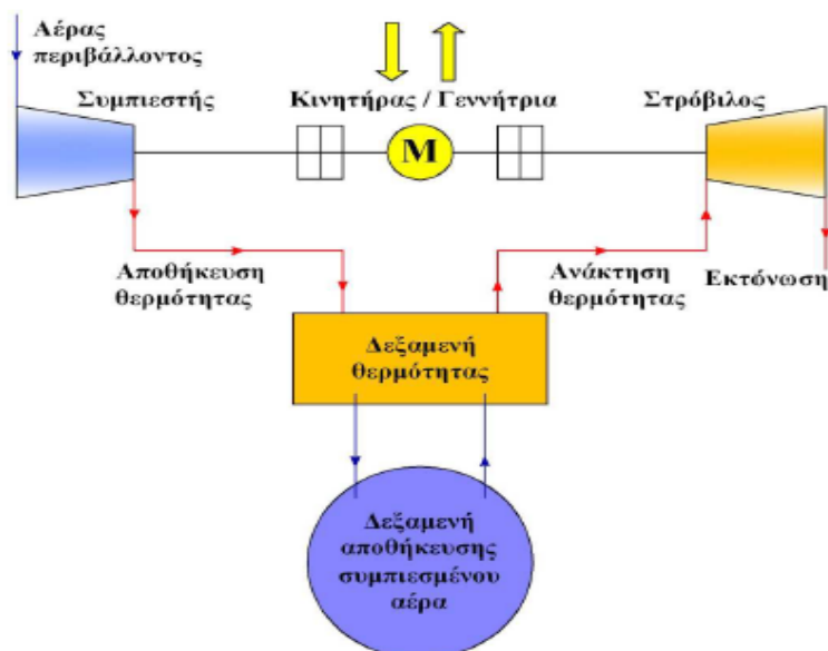
Εικόνα 5.7: Δομή και λειτουργία ενός αδιαβατικού CAES [2].
