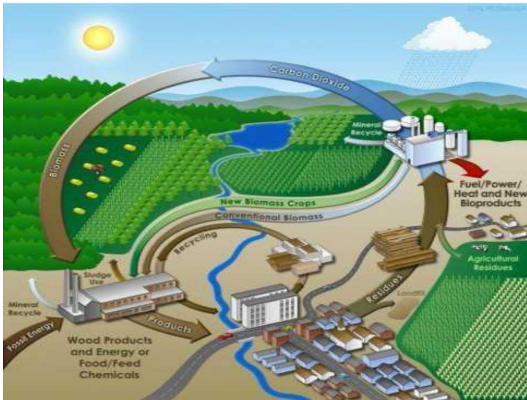
Εικόνα 3.2: Ενεργειακός κύκλος βιομάζας.
