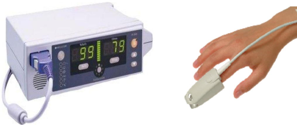
Εικόνα 19 : Φορητή συσκευή οξυμετρίας με το ακροδέκτη τοποθετημένο σε ένα δάκτυλο
