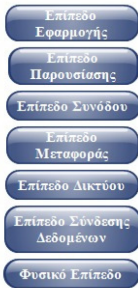
Εικόνα 5 Τα 7 πρώτα επίπεδα του μοντέλου αναφοράς OSI.
