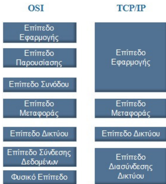
Εικόνα 6 Πως αντιστοιχίζονται τα επίπεδα του OSI με τα επίπεδα του TCP/IP
