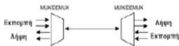
Σχήμα 2.30 Εκπομπή/λήψη στην ίδια οπτική ίνα.
