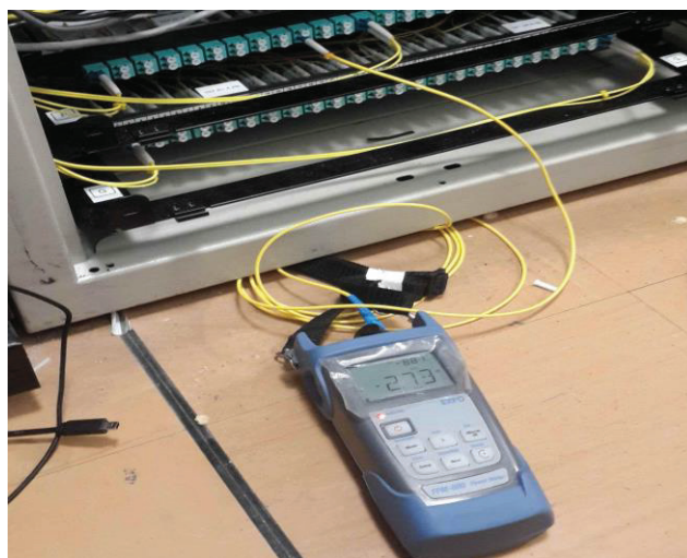
Σχήμα 6.4 Κομμάτι ίνας εξωτερικά του OTDR.
