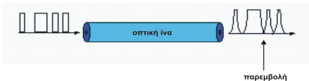
Σχήμα 2.12 Αλλοίωση παλμού ύστερα από χρονική στιγμή.
