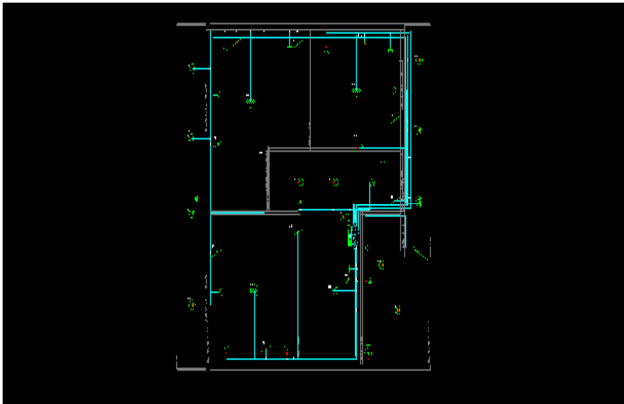
2.4 Κάτοψη ηλεκτρολογικών ορόφου μεζονέτας
