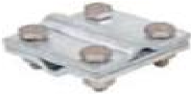
Εικόνα 4.7. Διμεταλλικός σύνδεσμος, Αγωγού 10 / Αγωγού 10 mm, ( 10/ 10), 3ων πλακιδίων, (Cu - St/tZn - με ενδιάμεσο πλακίδιο IN OX) ΚΩΔ. 007
