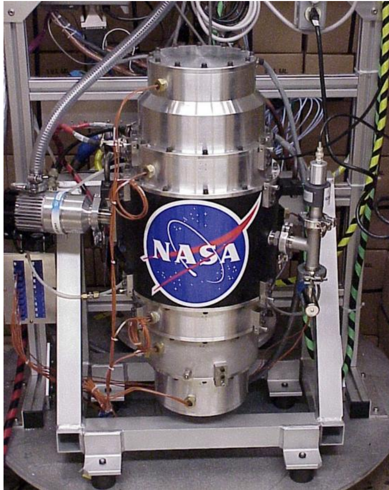
Εικόνα 30: Η μηχανή flywheel G2 της NASA
