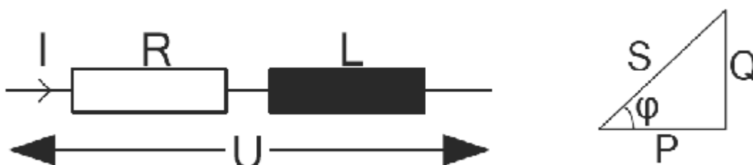
Εικόνα 4: Συντελεστής Ισχύος σε φορτίο με επαγωγικό χαρακτήρα
