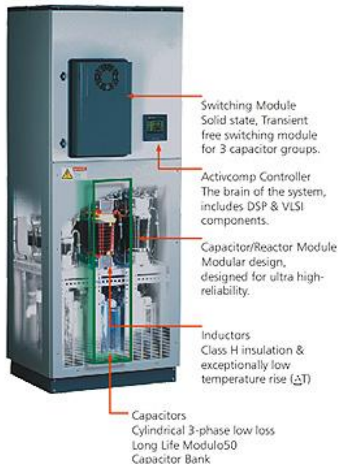
Εικόνα 21: Σύγχρονος στατός αντισταθμιστής που χρησιμοποιεί συσκευές ηλεκτρονικών ισχύος
