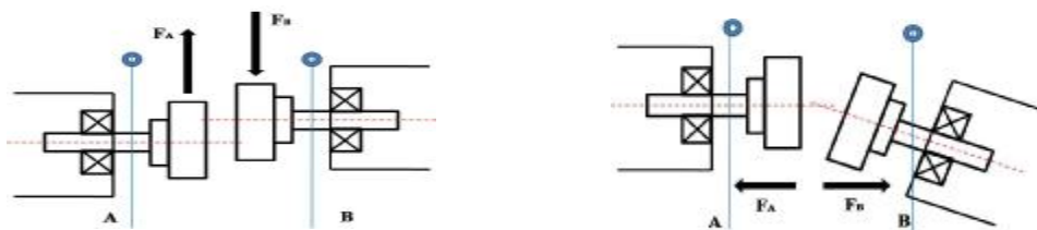
Εικόνα 8.4: Παράλληλη Απευθυγραμμία Εικόνα 8.5: Γωνιακή Απευθυγραμμία
