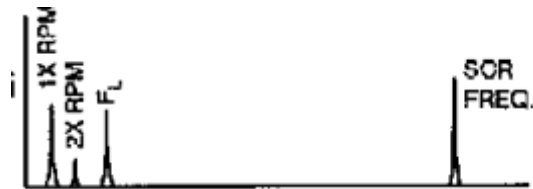
Διάγραμμα 8.25: Φάσμα συχνοτήτων σπασμένων περιελίξεων ή κακής ρύθμισης συστήματος ή προβλημάτων γείωσης
