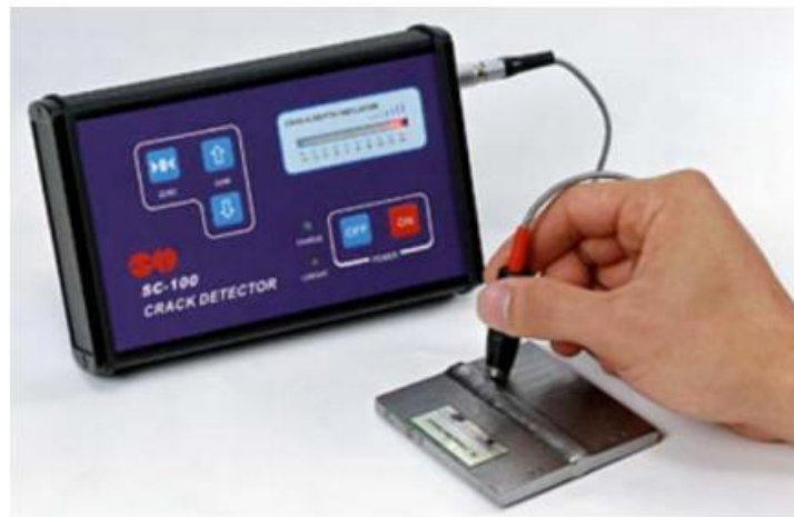
Εικόνα 2.10: Συσκευή ελέγχου με δινορρέυματα
