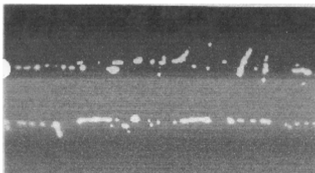
Εικόνα 2.13: Ανίχνευση εγκλεισμάτων με ραδιογραφία
