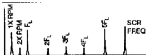
Διάγραμμα 8.26: Φάσμα συχνοτήτων ελαττωματικών SCR, καρτών ελέγχου και χαλαρών συνδέσεων
