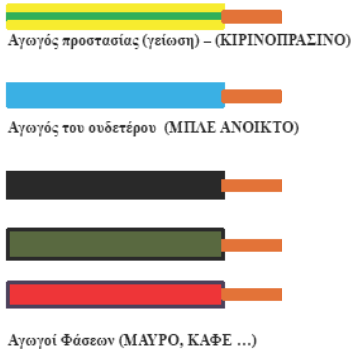
Εικόνα 3.2: Χρωματική σήμανση καλωδίων
