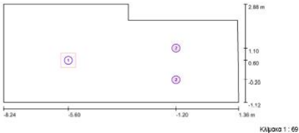
Εικόνα 1.7: Η διάταξη των λαμπτήρων στο υπόγειο
