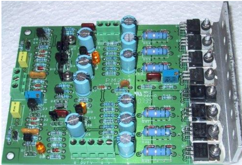
Εικόνα 17 Στην παραπάνω εικόνα φαίνεται ένας τελικός ενισχυτής
