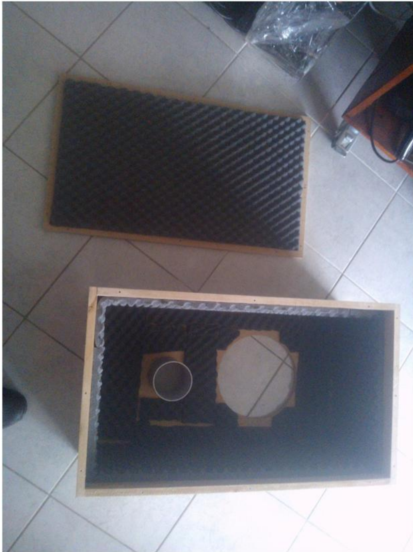
Εικόνα 43 Βλέπουμε το ηχομονωτικό υλικό στο εσωτερικό της καμπίνας, το οποίο κολλήθηκε με λαδόκολλα.
