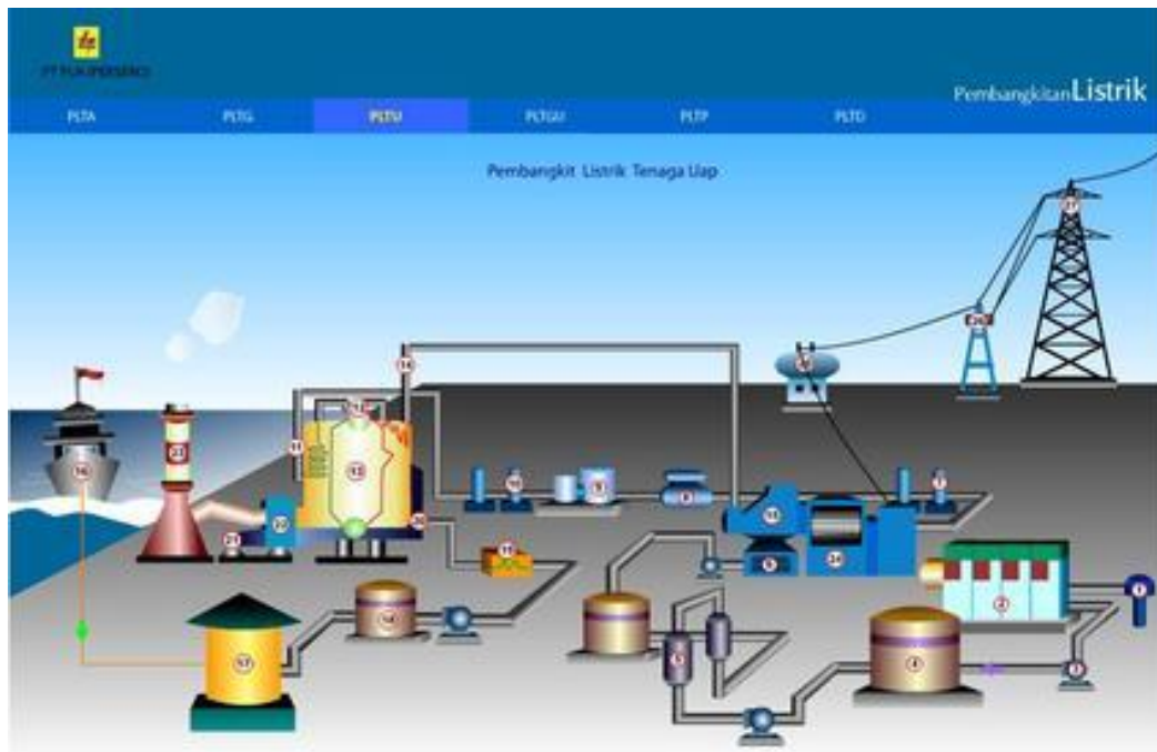
Εικόνα 36: Διάγραμμα ατμοηλεκτρικού σταθμού
