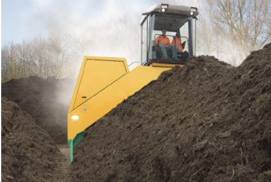
Εικόνα 5.3 : Ανοιχτό σύστημα κομποστοποίησης σε σειράδια με φυσικό αερισμό και μηχανική ανάδευση [Πηγή: Γάνος και συν., 2015]
