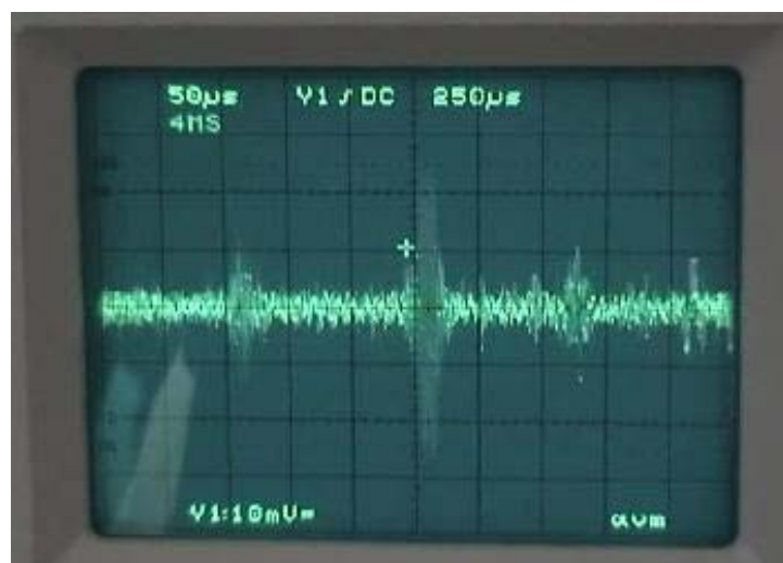
Εικόνα 67:Εικόνα οπτικού σήματος (Doppler burst - κροσσοί συμβολής) στον παλμογράφο.
