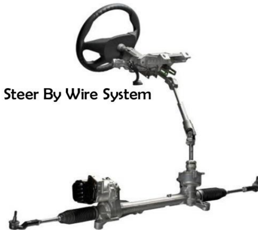
Σχήμα 11: Σύστημα ηλεκτρονικής οδήγησης (Google)
