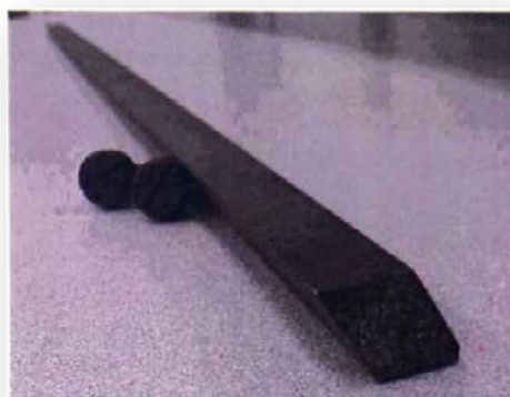
Εικόνα 17. Κωνικό GiB με βίδες. [42]
