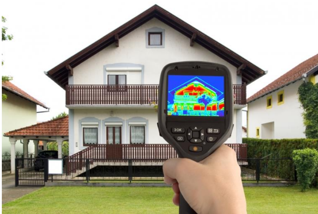
Εικόνα 2.6: Εντοπισμός απωλειών μέσω θερμοκάμερας [18]
