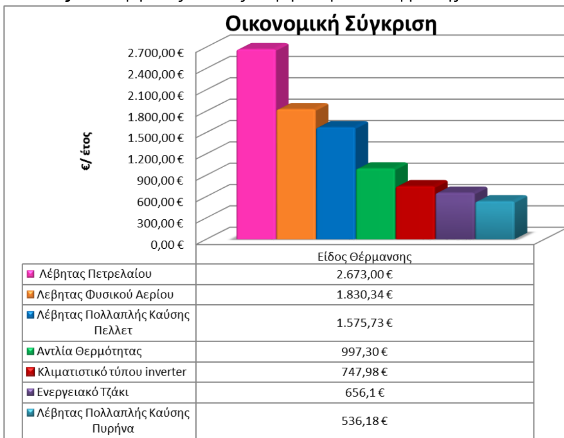
Πίνακας 5.6: Συγκριτικός πίνακας διαφόρων τρόπων θέρμανσης
