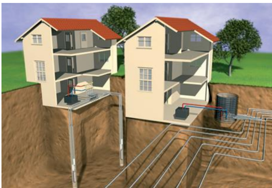
Εικόνα 6: Γεωθερμία και αντλία θερμότητας
