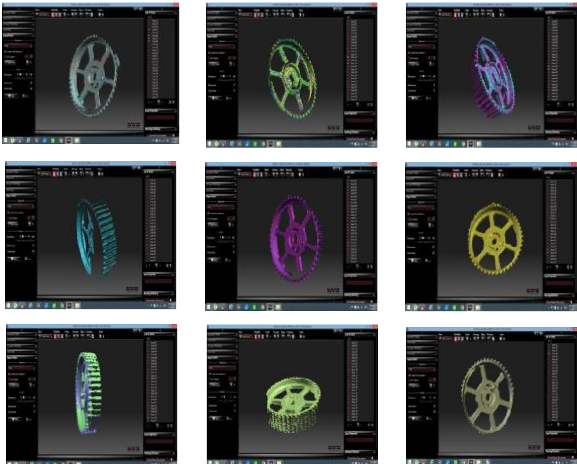
Εικόνα 40: Στιγμιότυπα απο την διαδικασία συρραφής του πλήθους των σαρώσεων
