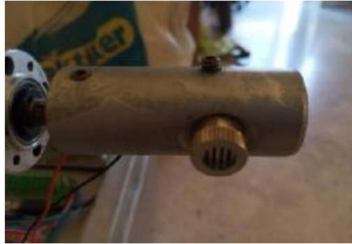
Εικόνα 33: Πηγή δέσμης ακτινών λέιζερ και μέθοδος συγκράτησης
