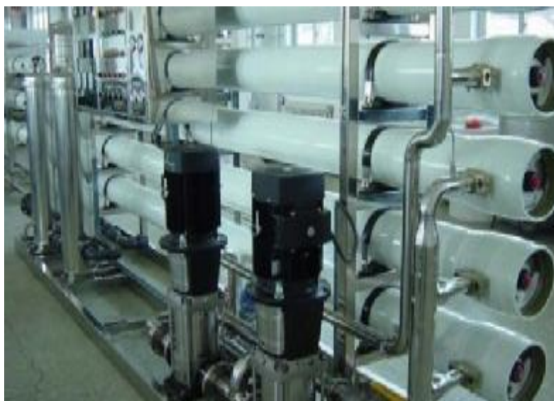
Εικόνα 3.9: Σύστημα επεξεργασίας νερού [4].
