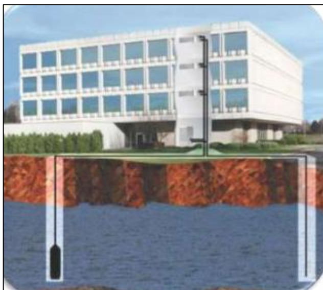
Εικόνα 24: Γεωθερμικός εναλλάκτης ανοιχτού κυκλώματος
