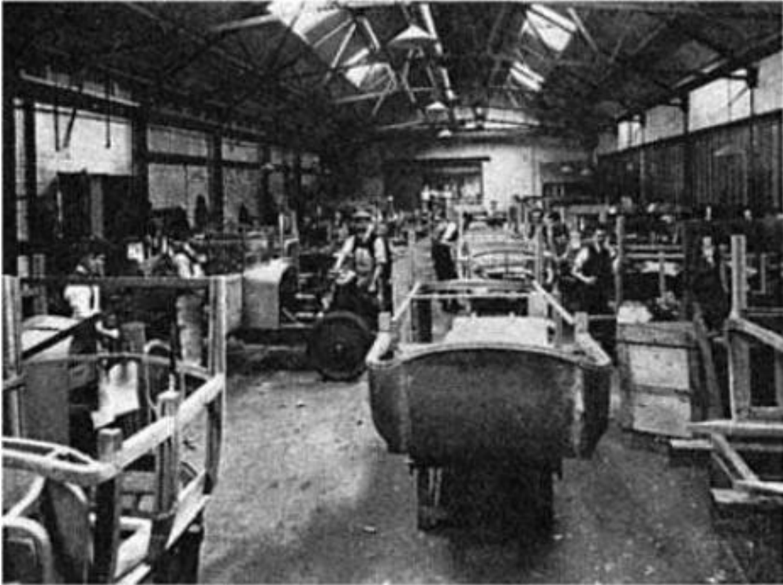
Εικόνα 43. Κατασκευή ξύλινων πλαισίων De Dion Works body shop, Finchley, c.
