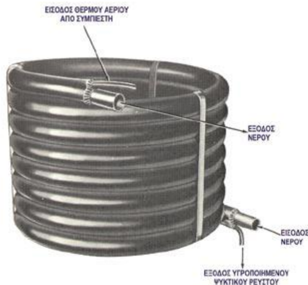
Σχήμα 46: Συμπυκνωτής διπλού σωλήνα
