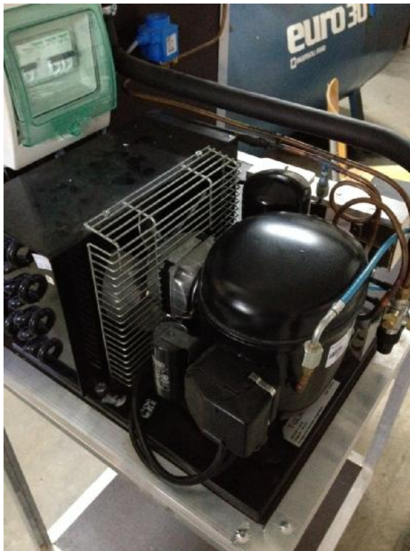
Σχήμα 58: Συμπιεστής (Electrolux GL90TB) και συμπυκνωτής με ανεμιστήρα (82CE-1305)
