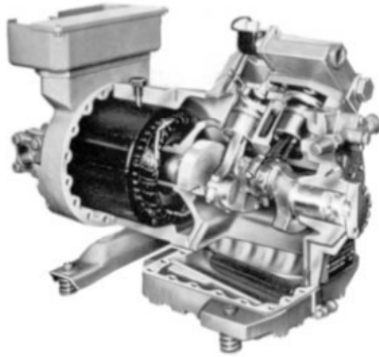
Σχήμα 18: Τομή ημιερμητικού παλινδρομικού συμπιεστή
