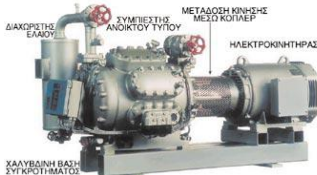
Σχήμα 15: Συγκρότημα ανοικτού τύπου συμπιεστή-ηλεκτροκινητήρα με μετάδοση κίνησης μέσω εύκαμπτου συνδέσμου
