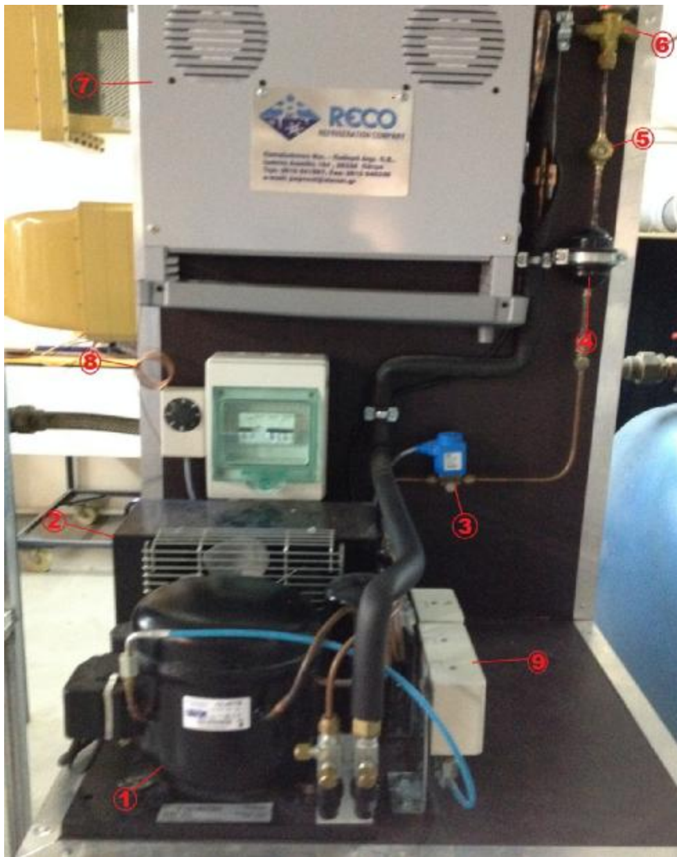
Σχήμα 57: Εργαστηριακή αντλία θερμότητας με τα διάφορα μέρη της
