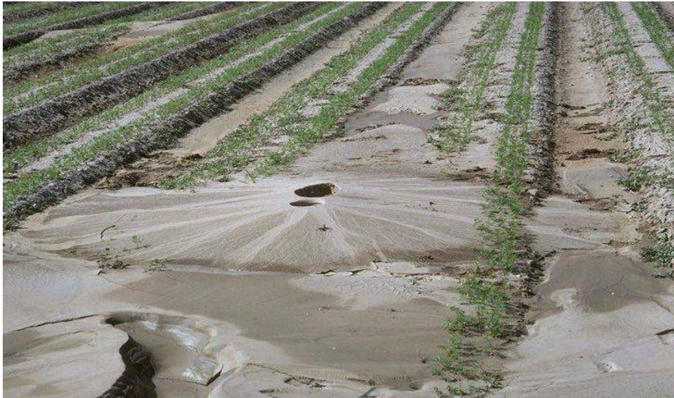
Εικόνα 2.3 Φαινόμενο ρευστοποίησης με κυκλικά επαναλαμβανόμενη ροή υπό τη μορφή ηφαιστειού άμμου. Σεισμός του 1979 στο El Centro.
