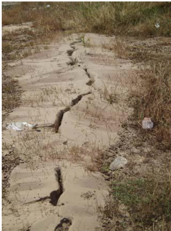
Εικόνα 3.10: Κάτω Αχαΐα – ανατολικά Εδαφικές ρωγμές χωρίς ανάδυση λεπτόκοκκου υλικού. Οριζόντια μετατόπιση από 4 έως 8cm και κατακόρυφη μετατόπιση από 3 έως 6cm
