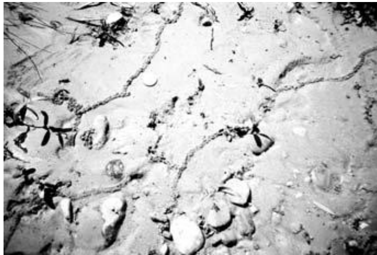
Εικόνα 3.2: Βασιλική: Εδαφικές διαρρήξεις με ανάδυση λεπτόκοκκου υλικού
