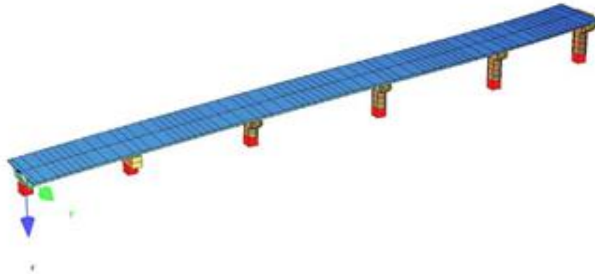
Σχήμα 3.2: Προσομοίωμα φορέα ανωδομής.
