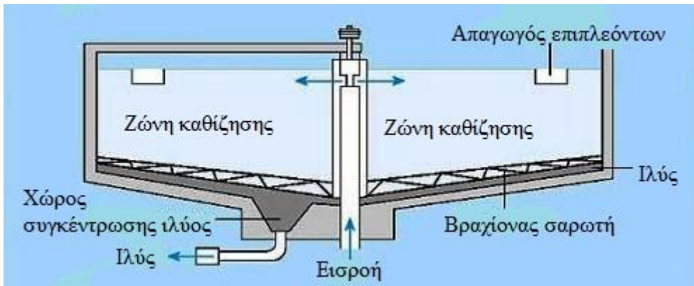
Σχήμα 4-4. Στάδια επεξεργασίας νερού σε κυκλική δεξαμενή
