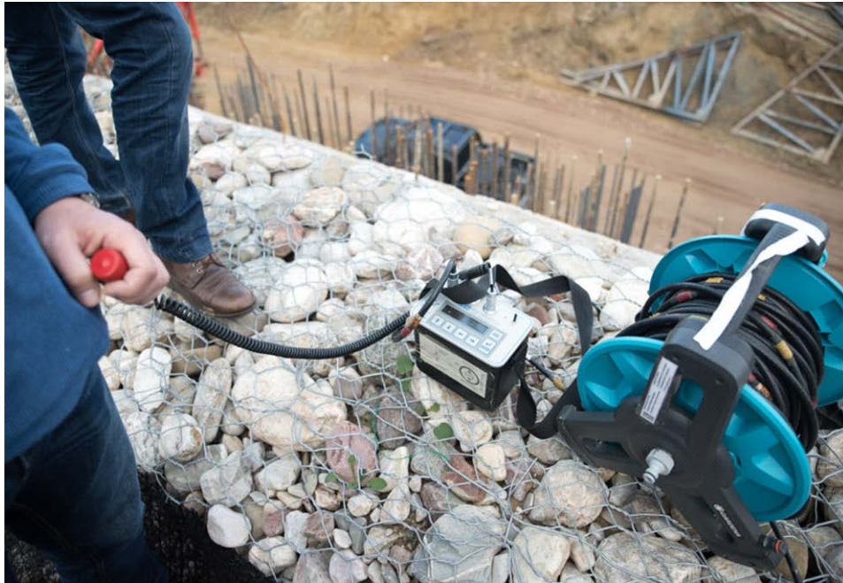
Σχήμα 4.5 Ηλεκτρονικό καταγραφικό με εντολέα και το καλώδιο σύνδεσης-μεταφοράς των δεδομένων της μέτρησης
