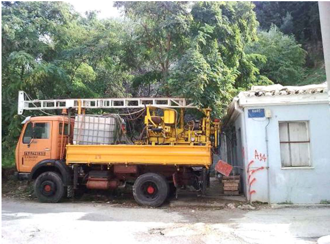
Σχήμα 1.18 Γεωτρύπανο με το στέλεχος του να είναι μαζεμένο στην καρότσα του μικρού φορτηγού με το οποίο μεταφέρεται.
