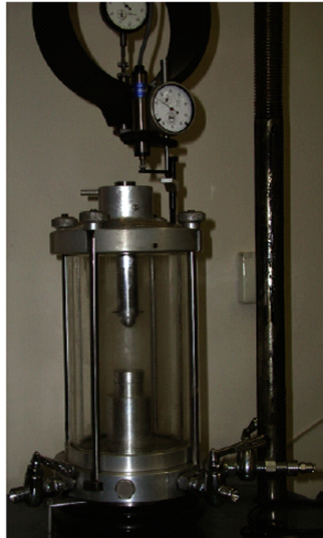
Σχήμα 1.22 Διάταξη τριαξονικής δοκιμής – κυψέλη, σχεδιάγραμμα (α) (Craig, Soil Mechanics), φωτογραφία (β)
