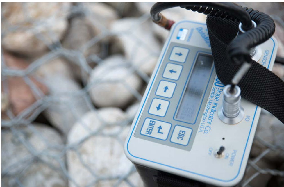
Σχήμα 4.6 Ηλεκτρονικό καταγραφικό αποκλισημετρικού σωλήνα με ενδείξεις από την μέτρηση που έγινε από το Πανεπιστήμιο Πατρών
