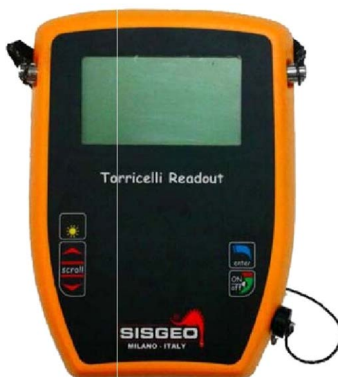
Σχήμα 4.14 Καταγραφικό όργανο που χρησιμοποιείται για την ανάγνωση της ένδειξης των κλισιμέτρων
