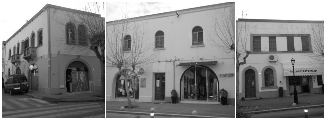
Εικόνα 22. Τμήμα 4,5 και 1(επί της Λεωφόρου Ιπποκράτους). 473 Παρατηρήσεις: Συμμετρική διαμόρφωση ανοιγμάτων σε ζώνες. Διαφοροποίηση ισογείου και ορόφου τονίζοντας τη διαφορετική χρήση. Παρουσιάζουν κοινά μορφολογικά στοιχεία αλλά το τμήμα 4 έχει πιο εκλεκτικιστικό ύψος και πιο πλούσιο διάκοσμο.
