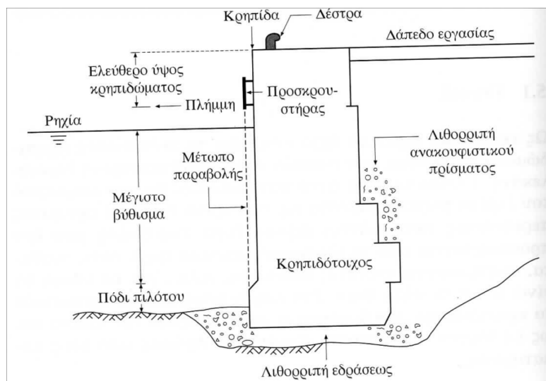
Σχήμα 1: Διαμόρφωση και στοιχεία Κρηπιδώματος από Μέμο (2008).
