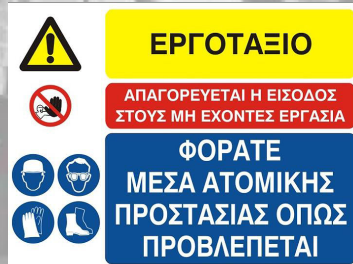
Εικόνα 159: Πινακίδες Ασφαλείας Εργοταξίου
