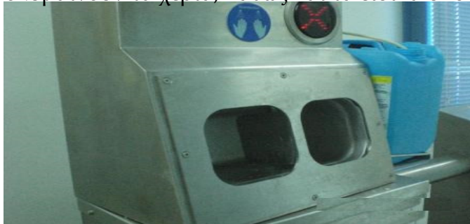
Εικόνα 45 Αυτόματο μηχάνημα για πλύσιμο και απολύμανση χεριών.
