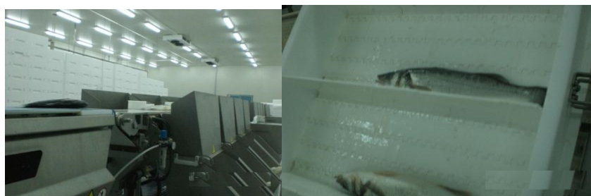
Εικόνα 33: Ιμάντας που μεταφέρει τα ψάρια και ιμάντας με θήκες
